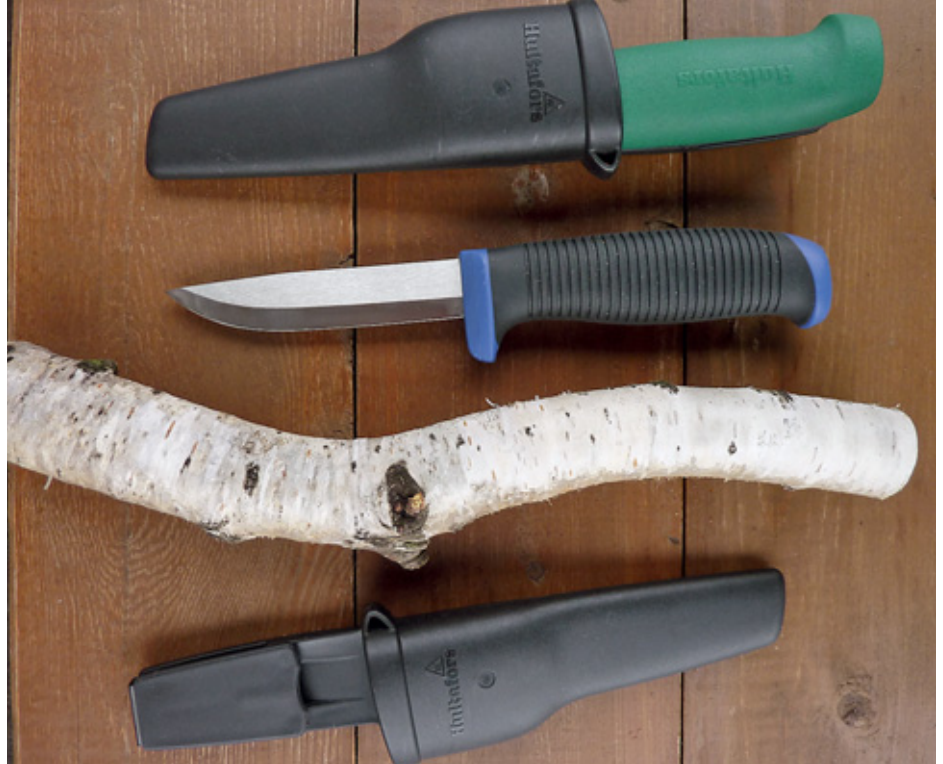
Ножи Hultafors . Нож с зелёной рукоятью предназначен для выполнения работ с использованием силового реза. Его клинок толще в обухе и изготовлен из высокоуглеродистой стали. Нож со вставками синего цвета с клинком из японской нержавеющей стали AUS-8
