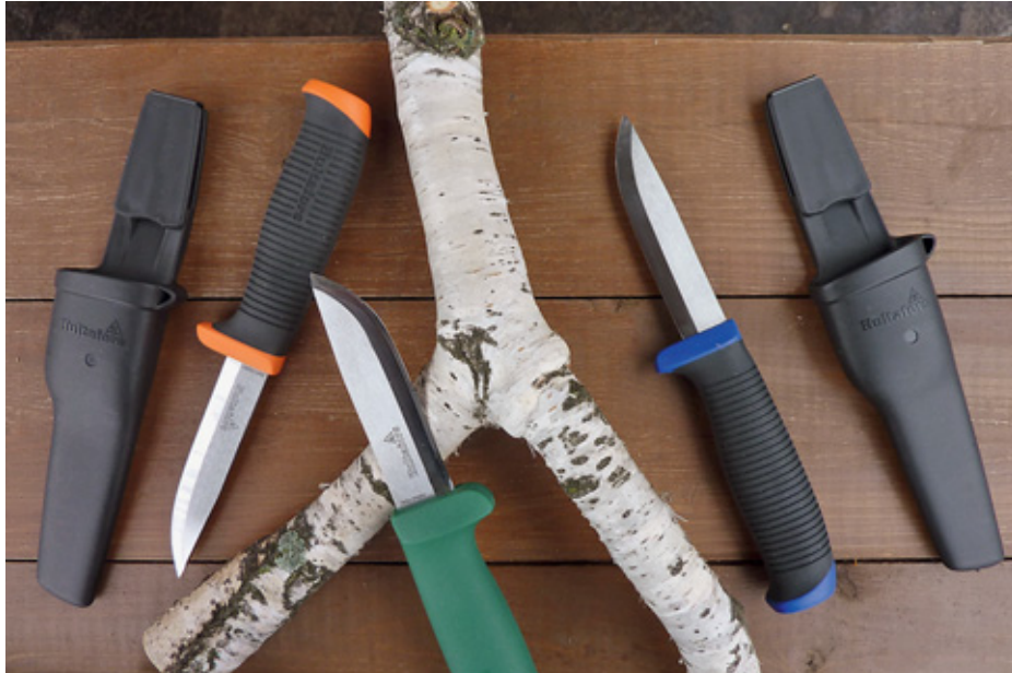
Шведские профессиональные рабочие ножи Hultafors. Первый слева с оранжевыми вставками вместо bolsterов с клинком из высокоуглеродистой стали. С зелёной рукоятью – прочный нож для тяжёлых работ с утолщённым клинком из высокоуглеродистой стали. Третий нож с чёрной рукоятью и синими вставками имеет клинок из AUS-8
